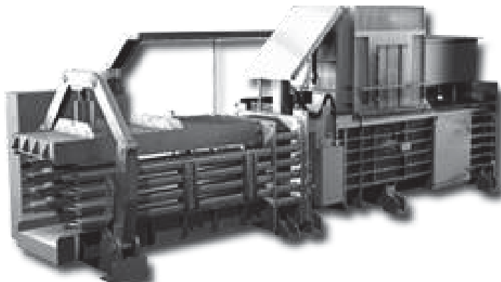
Slika 27. Horizontalna balir presa sa uređajem za vezivanje (model BankPRO)
